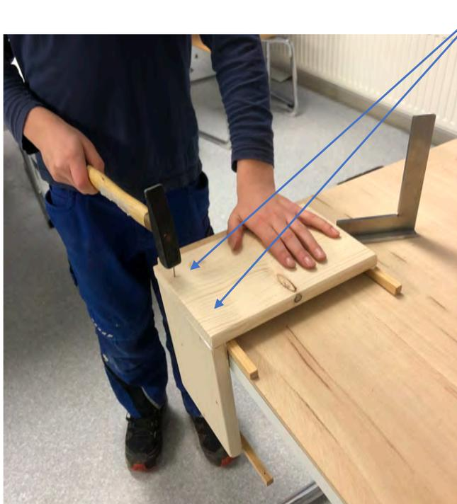
Dreh das Dach danach um und schlage noch einmal von unten auf das kurze Brett.
