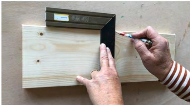
Abmessen und im Anschluss mit dem Anschlagwinkel den Sägeschnitt markieren.
