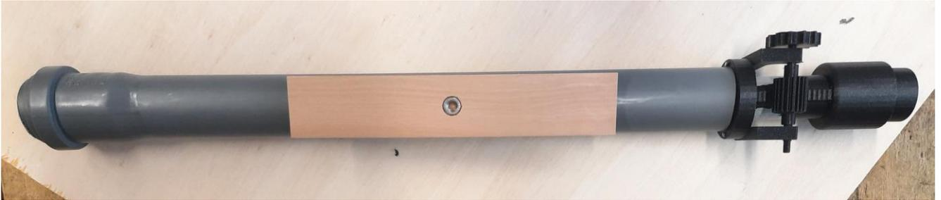
Mit dem Stativadapter kann das Teleskop auf dem Stativ angebracht werden. Das Teleskop steht stabil und mit dem Zahnrad am Okularauszug kann das Bild scharf gestellt werden.
