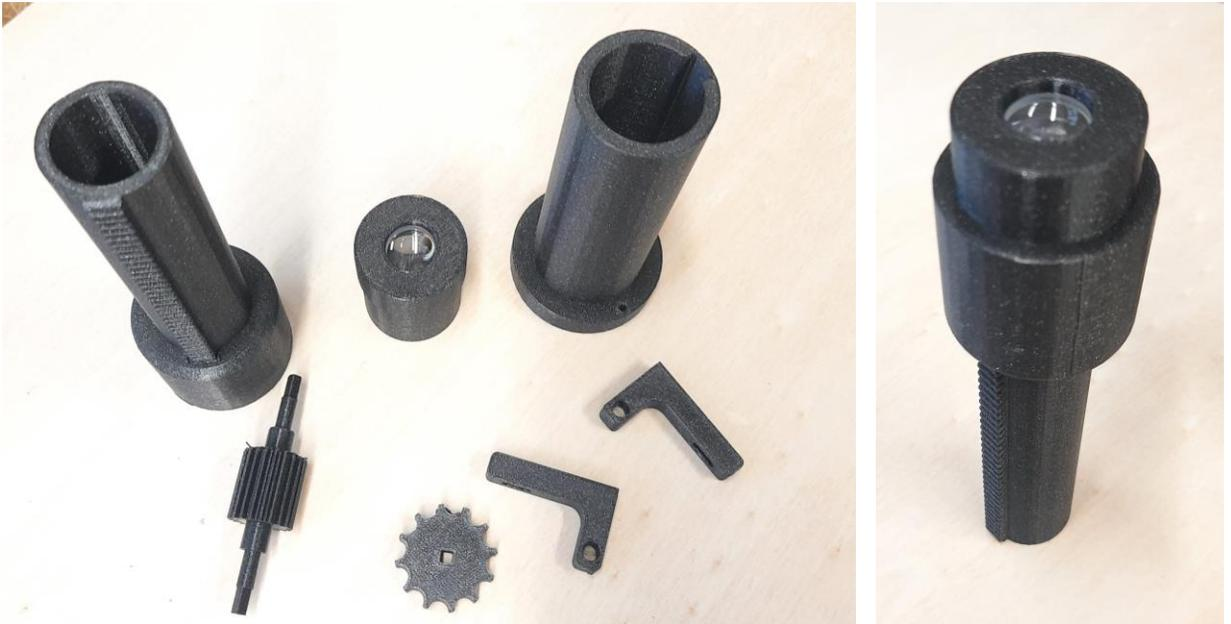
Das fertige Okular kann nun in den Okularauszug (Rohr mit Zahnstange – auf dem Bild oben links) gesteckt werden. Sollte das Okular ein wenig wackeln, kann vorher noch ein Streifen Tesafilm um das Okular geklebt werden.
