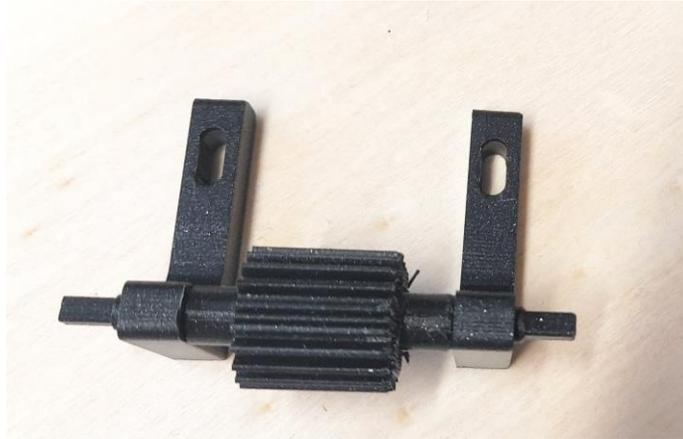
Die L-Stücke werden so auf den Rohradapter gelegt, dass die ovalen Löcher über den Schraubenlöchern des Rohradapters liegen. Mit zwei Schrauben werden die L-Stücke am Rohradapter fixiert.
