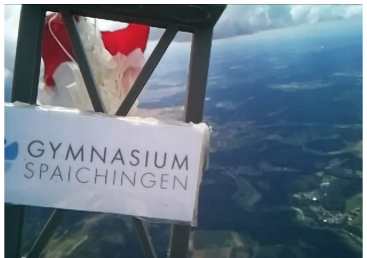
Abbildung 9: Bild des Verknoteten Fallschirms (rot) neben, anstatt über der Kapsel
