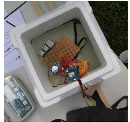
Abbildung 6: Das Innere Der Kapsel (der Raspberry Pi ist hier noch nicht fixiert)
