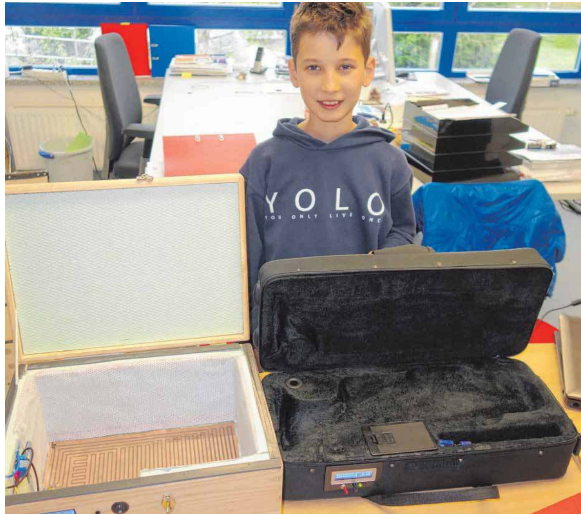
Links für ein Horn, rechts für die Trompete. Modelle für beheizbare Instrumentenkoffer hat Thomas Majer schon gebaut. Schwierig ist die Energieversorgung über einen Akku.
