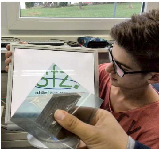
Spionagebildschirm aus Eningen: erst der Polarisationsfilter ermöglicht es, etwas auf dem Bildschirm zu sehen. Ohne bleibt der Bildschirm eine weiße Oberfläche
