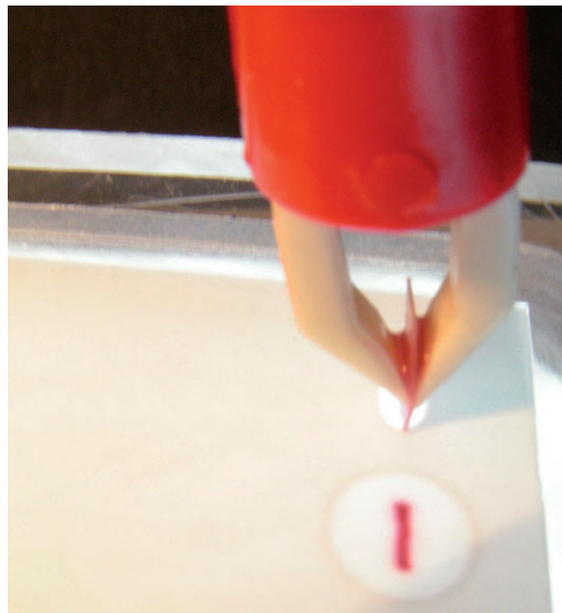
Abb. 2 Auftragung mit einem Filterpapierstreifen: Der Filterstreifen wird von der Zeckenzange gehalten, die Probe wird in das Greiferdreieck gegeben und fließt bei Kontakt mit der Platte durch den Filterstreifen.
